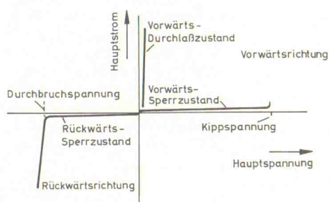
Bild 22. Typische Kennlinie eines Thyristors.
