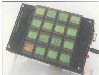
Beispielausführung eines 4 x 4-Tastenfelds auf Basis der programmierbaren Taste LC 16 von Hohe Electronics.
